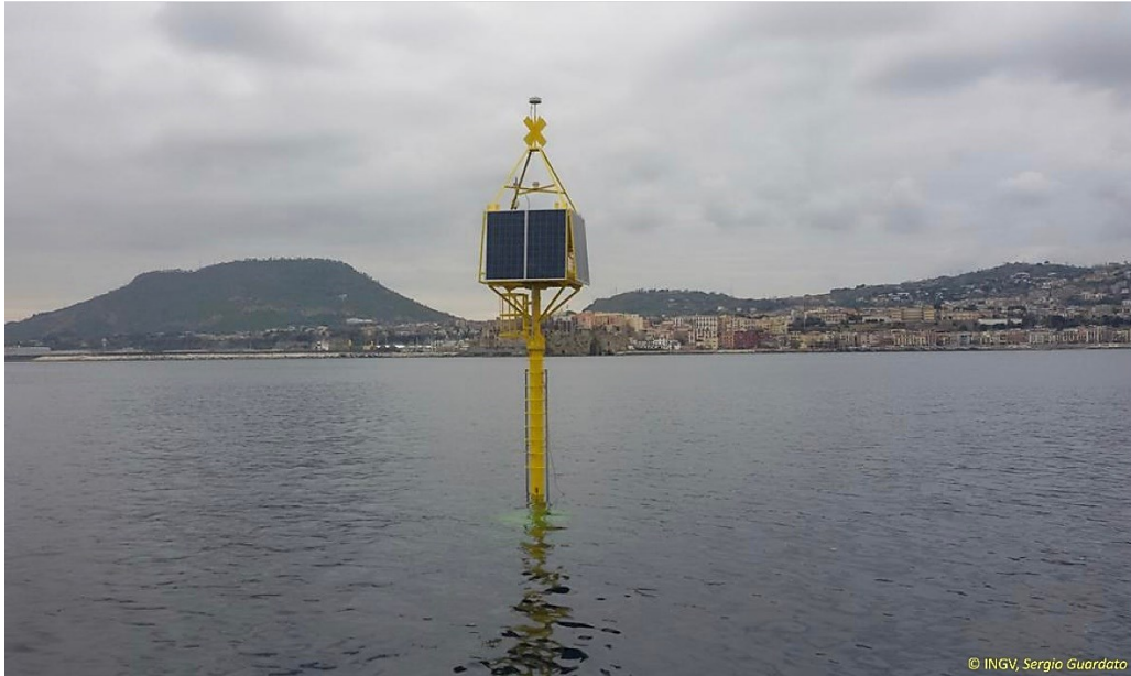
Fig.20: Parte emersa di una boa geodetica appartenente al progetto MEDUSA (fonte: Guardato et al., post blog INGV Vulcani, 25/09/2018).
