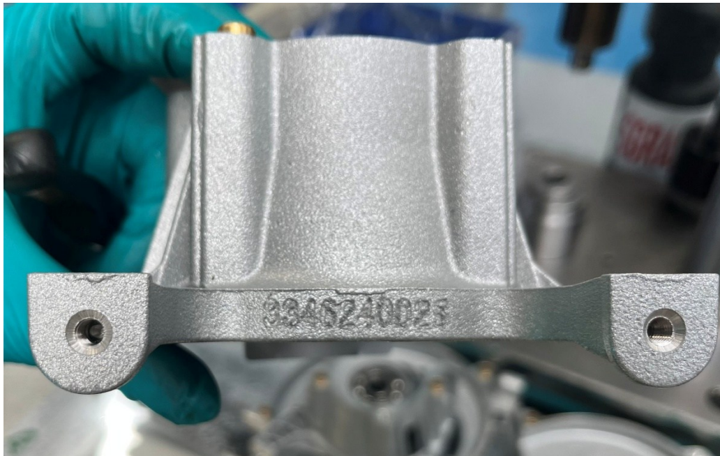
Figura 13: Codice macchina punzonato in prima fase
