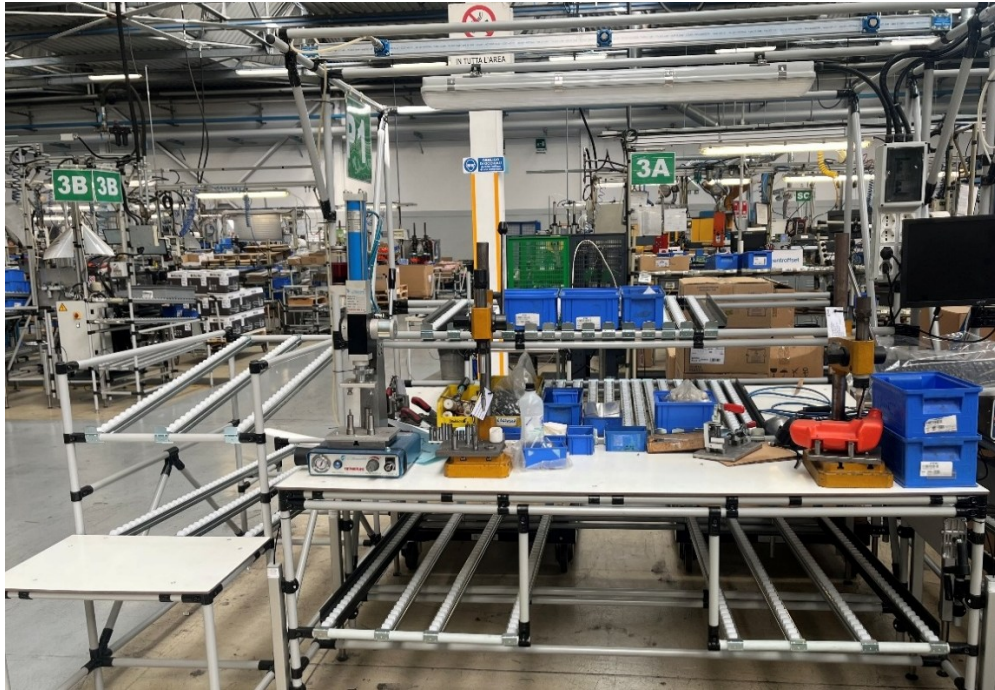
Figura 18 Foto banco 4 serbatoi con relative attrezzature e piano laterale per l'appoggio di materiale di linea
