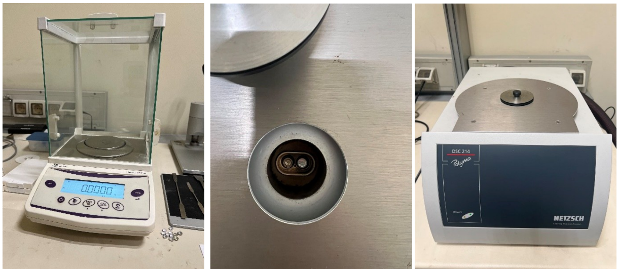
Figura 5.1: Fasi per l'analisi DSC: pesatura campione, posizionamento nella cella e azionamento della DSC 214 Polyma
