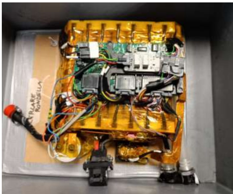
(Imm. 6.5 Pacco Batteria 14s3p con Cold Plates)
