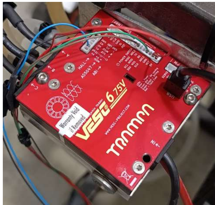
(Imm.3.5 Inverter utilizzato durante lo sviluppo dei motori IPM a banco prova)
