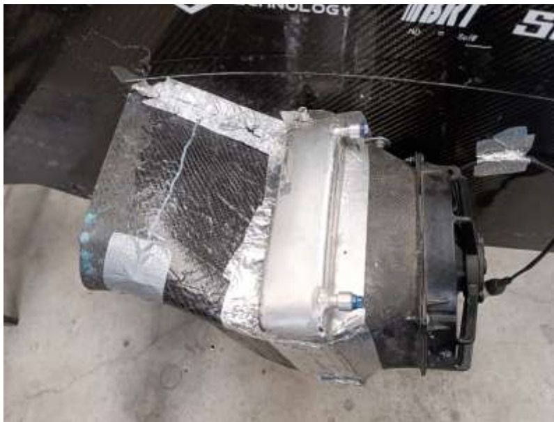
(Imm.4.1 Scambiatore di calore principale del propulsore della monoposto)
