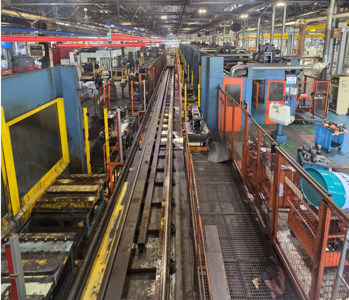
Figura 1.3: Vista assiale della linea dalla piattaforma rialzata: binario di asservimento centrale e centri di lavoro MSR a destra, Scharmann (bianco) a sinistra.
