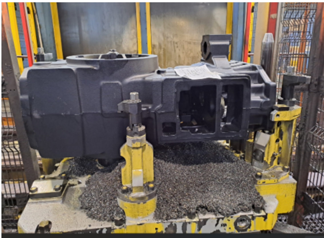
Figura A.1: Esempio di accumulo di truciolo su attrezzatura: rischio contaminazione sedi e instabilità di posizionamento.
