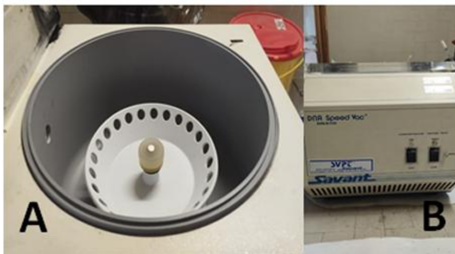
Figura 4.5: nell'immagine A viene mostrato come si presenta lo SpeedVac all'interno; immagine B mostra i parametri da impostare.
