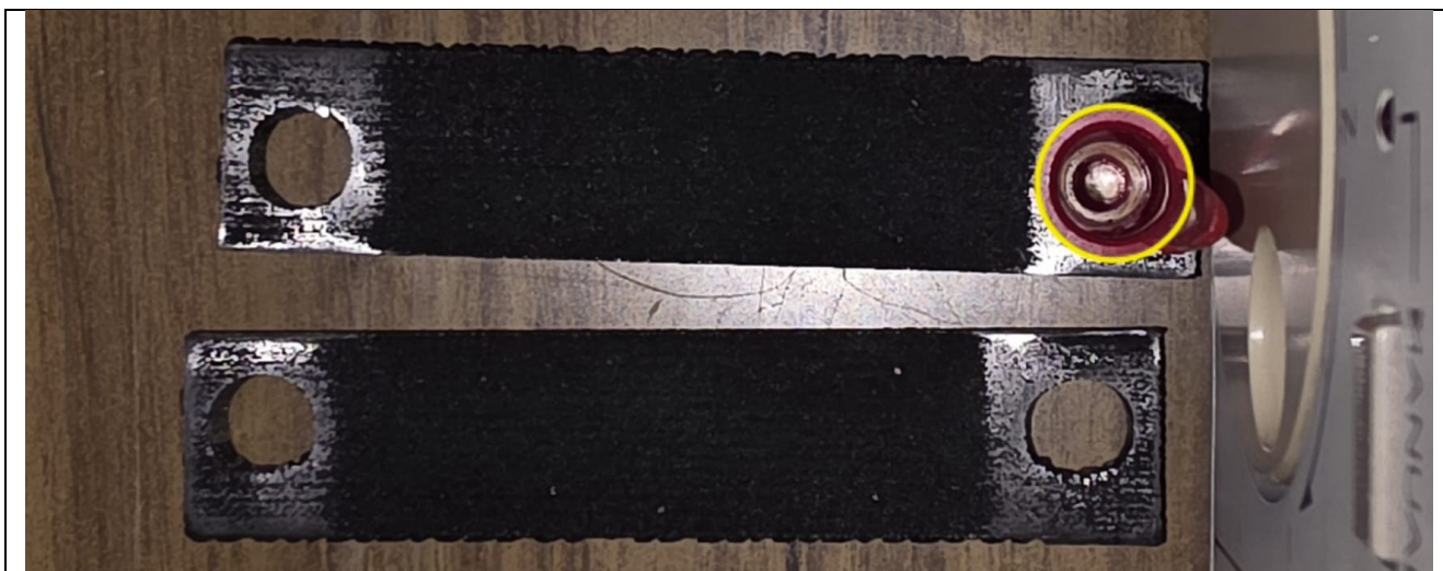
Figura 6 : scarsa precisione geometrica delle circonferenze dei fori passanti
