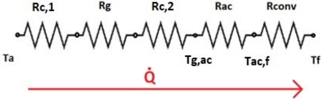
Figura 3.13: Resistenze termiche in serie
