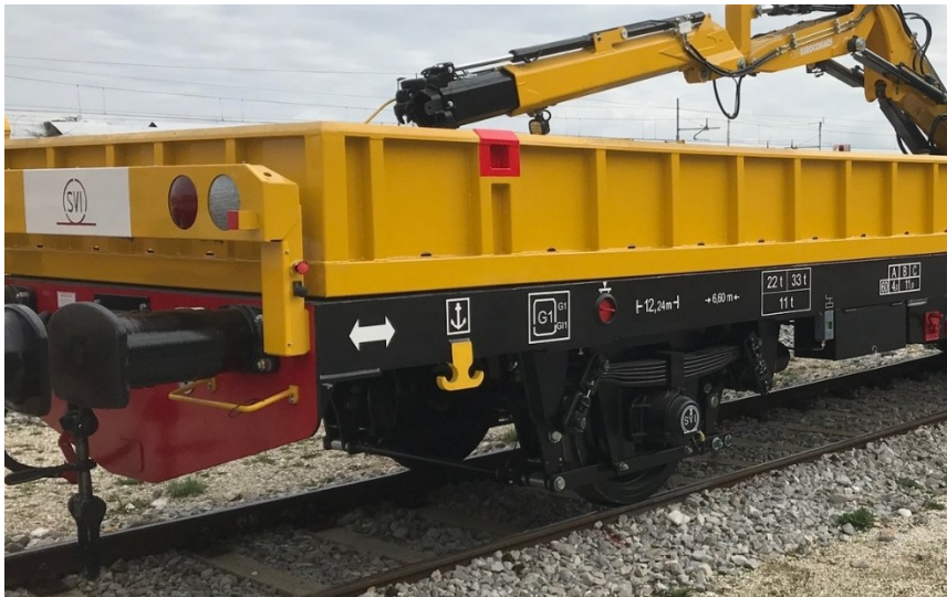
Figura 2.11: Rimorchio ferroviario con la sola sospensione principale (fonte:[11]).
