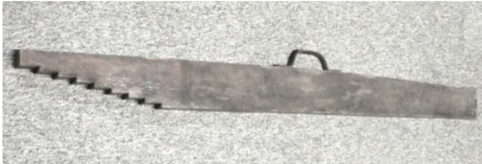
Figura 2.7: Strumento per misurare la sopraelevazione di un binario (fonte: [5]).
