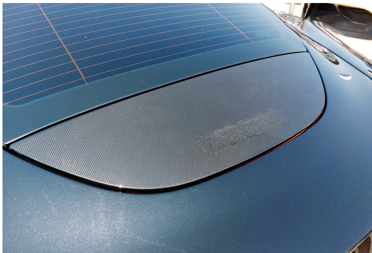
Figura 1.29: Posizionamento mostrina in vettura, in questo caso nella variante in fibra di carbonio. (credits: google images)
