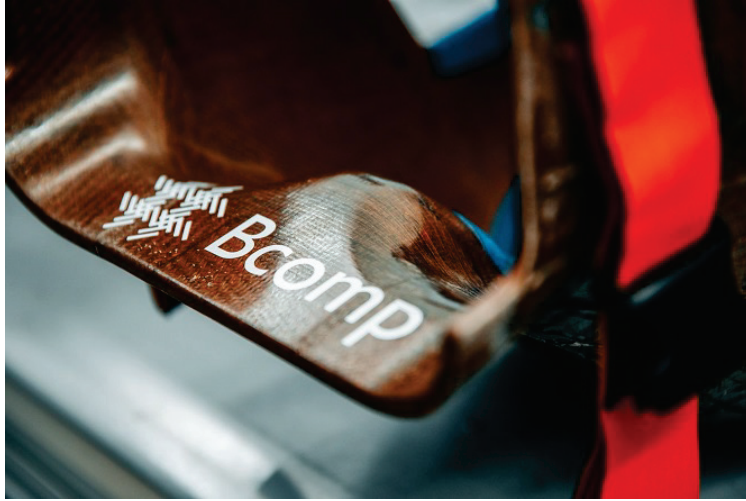
Figura 1.2: Dettaglio fibra di lino per sedile McLaren F1. [8]
