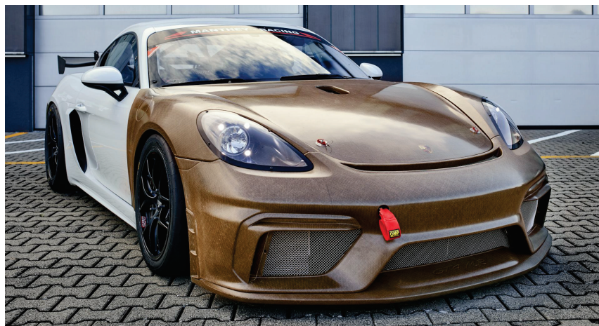
Figura 1.4: Bodykit installato su una Porsche 718 Cayman GT4 Clubsport MR, concorrente alla 24 ore del Nurburgring del 2021. [9]
