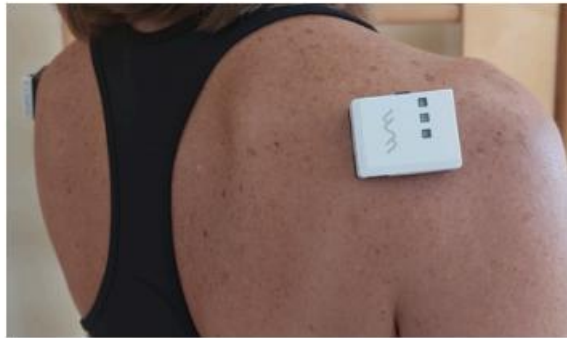
Figura 19. Posizionamento del sensore scapolare.
