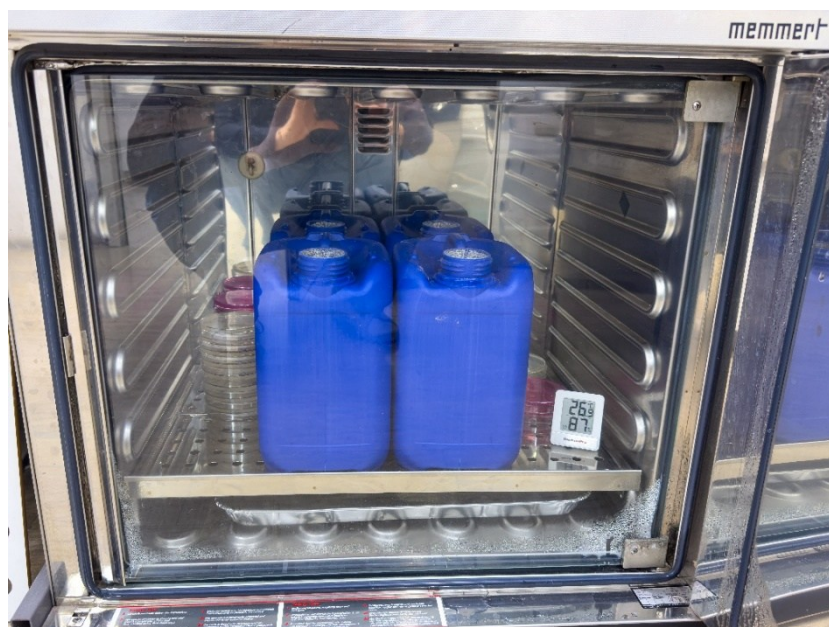
Fig. 31 – L'incubatore Memmert BM 500 con all'interno i 4 contenitori nei quali sono stati stoccati i campioni di mais. Sul fondo la vaschetta in alluminio contenente l'acqua per il mantenimento dell'UR; sulla destra il termoigrometro digitale.
