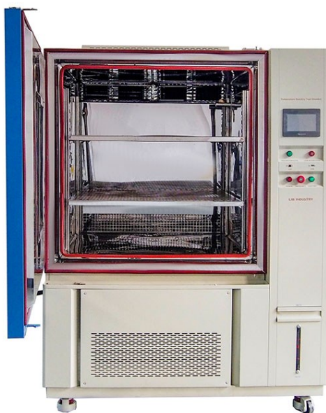
Figura 7 Esempio di Camera climatica da laboratorio utilizzata durante le prove
