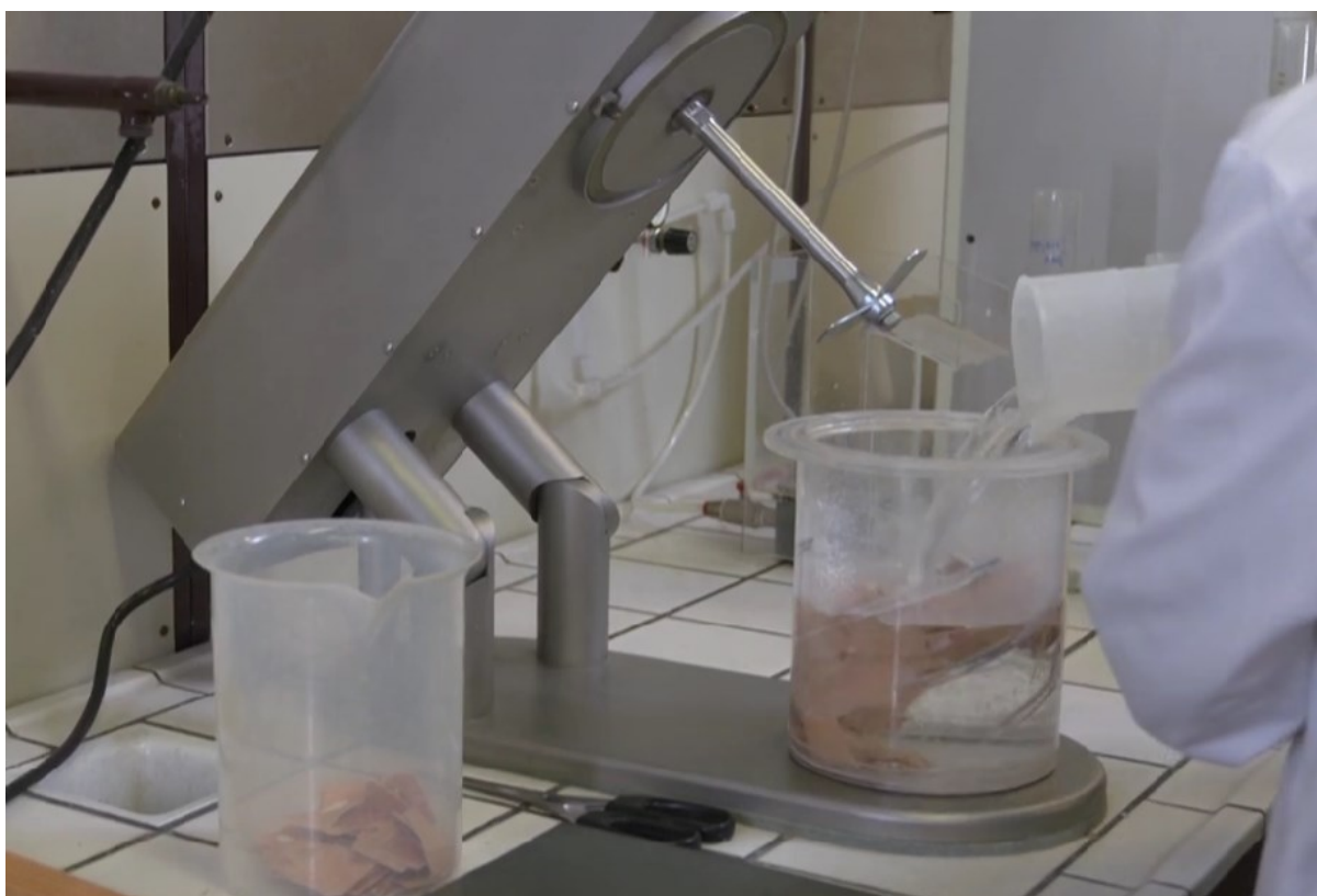
Figura 4 Processo di disgregazione della carta come da norma UNI 11743
