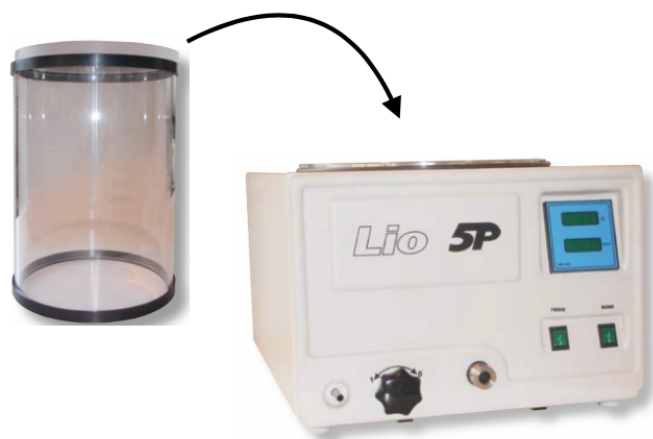
Figura 8. Liofilizzatore utilizzato in questo studio: LIO 5P 4K (SARIN).
