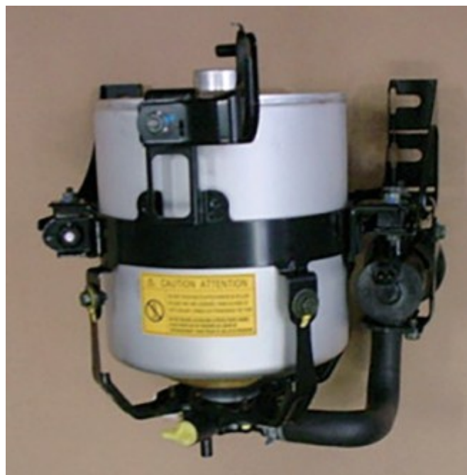
Figura 2.5: Foto del serbatoio CHS a vuoto della Toyota Prius Gen II NA [34]
