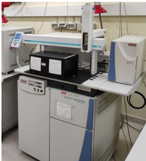
Figura 21: Sistema EQ-IRMS costituito da spettrometro di massa per rapporti isotopici (IRMS) accoppiato a sistema GasBench.
