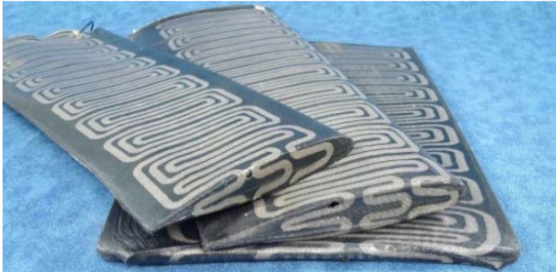
Figura 3.9: Profilo Alare con superficie in SMP[7]
