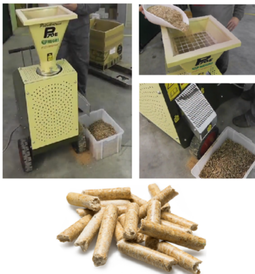
Figura 2.10: Pellettatrice da 3 kW con una capacità produttiva di 40 kg/h. Il cippato, alimentato dall'alto, viene trasformato in pellet (immagine in basso). Frame estratti dal video dimostrativo dell'azienda "Negri". 34
