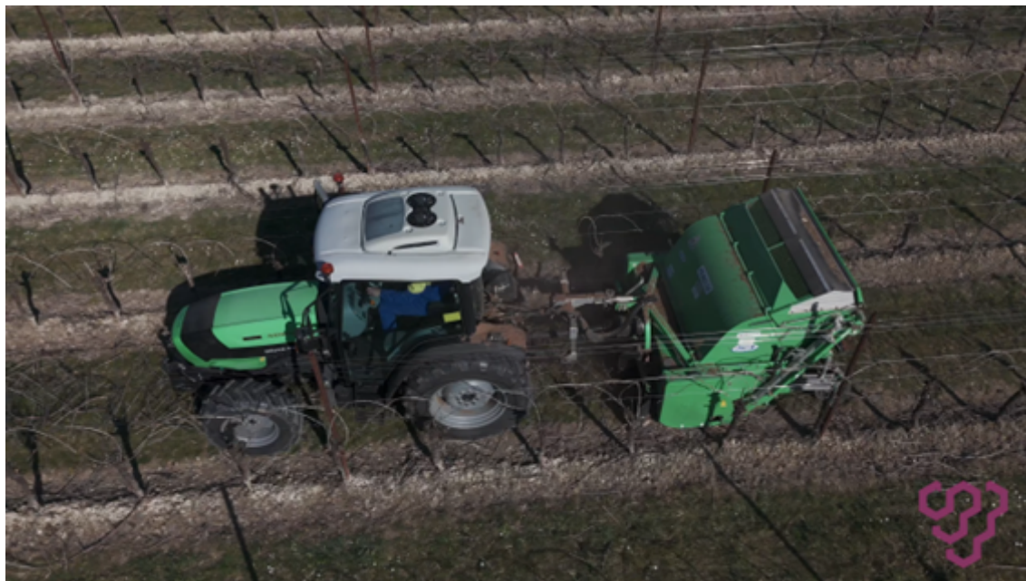
Figura 2.1: Trinciatrice per sarmenti all'opera: la macchina è trainata da un trattore di piccola taglia, in grado di muoversi agevolmente lungo i filari del vigneto (dimostrazione a video del canale EnoVi Channel ).
