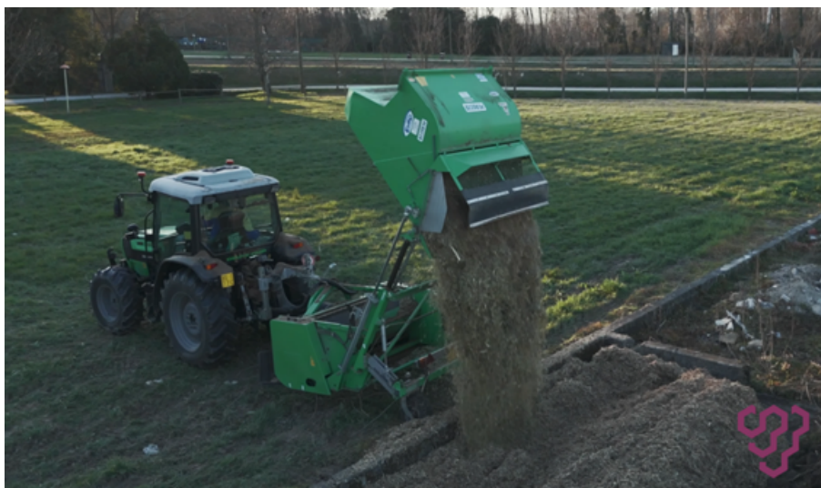
Figura 2.2: I sarmenti raccolti e sminuzzati dalla trinciacaricatrice vengono scaricati all'interno di appositi raccoglitori (dimostrazione a video del canale EnoVi Channel ).
