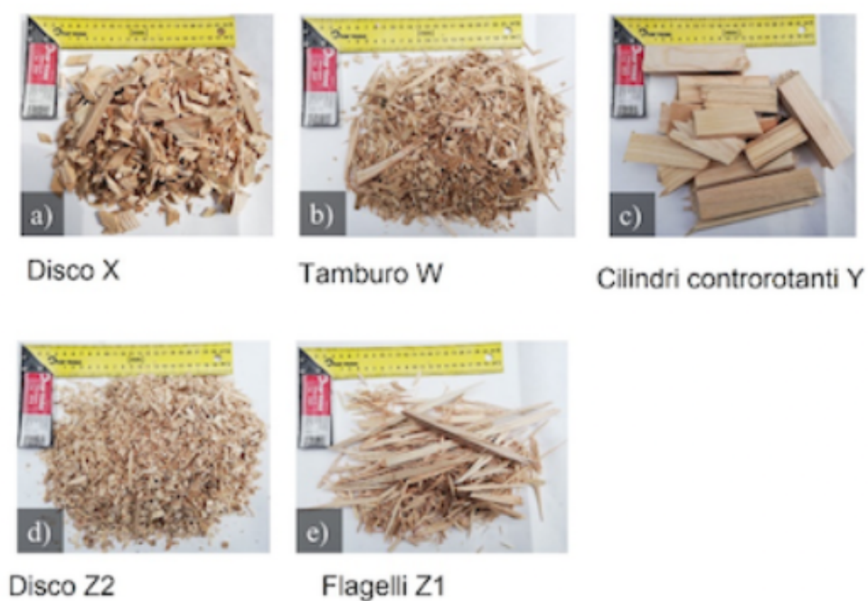
Figura 2.3: Diverse forme di cippato, ottenute con bio-triturator di vario tipo. La pezzatura del materiale sminuzzato dipende dal sistema di taglio di cui è dotata la macchina. Studio di M.Rosato 22
