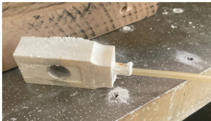
Figura 3.2-3: Distributore dell'elettrolita nel meato di lavorazione
