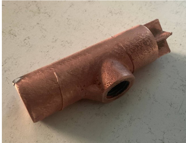
Figura 5.1-1: Elettrodo ibrido a valle del processo di elettrodeposizione galvanica massiva, caratterizzato da uno spessore di rame depositato di 0,25 mm. Il componente è pronto per l'installazione sul mandrino per i test ECM.
