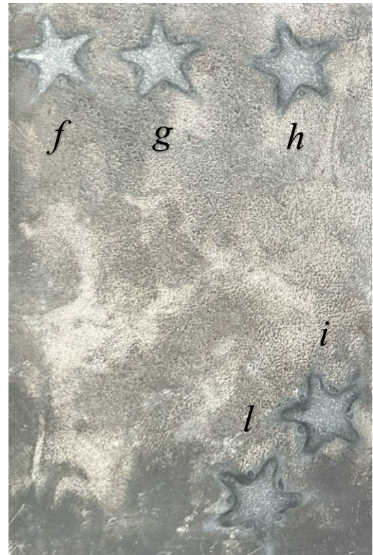
Figura 5.4-1: Vista macroscopica delle piastre lavorate in regime statico. A sinistra gli scavi superficiali a 12 V. A destra le lavorazioni a 24 V. a) S_10_12. b) S_30_12. c) S_60_12. d) S_90_12. e) S_120_12. f) S_10_24. g) S_30_24. h) S_60_24. i) S_90_24. l) S_120_24.
