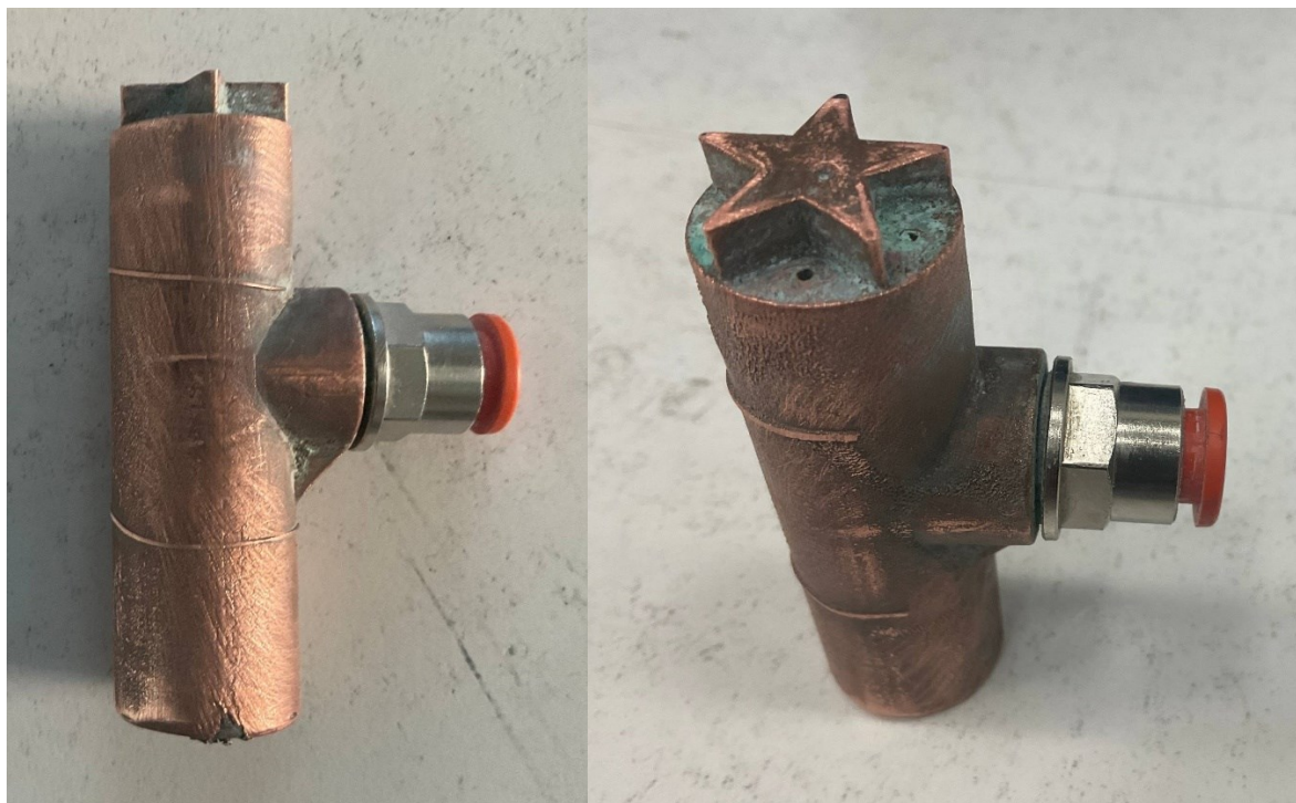
Figura 5.9: Stato di conservazione finale dell'elettrodo ibrido al termine dell'intera campagna sperimentale. Il rivestimento in rame risulta strutturalmente integro e privo di delaminazioni. È visibile unicamente la fisiologica patina di ossidazione superficiale (cloruro/ossido di rame) indotta dall'interazione con l'elettrolita salino (NaCl).
