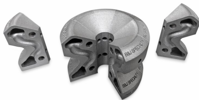
Figura 2.2-4: Sezione di un componente per tooling (stampo o elettrodo) dotato di canali di raffreddamento/lavaggio conformati (conformal cooling channels). Realizzabili esclusivamente tramite tecnologie di Additive Manufacturing (AM), questi circuiti interni complessi e curvilinei seguono parallelamente la morfologia esterna del pezzo, garantendo una distribuzione fluidodinamica e termica ottimale e uniforme.
