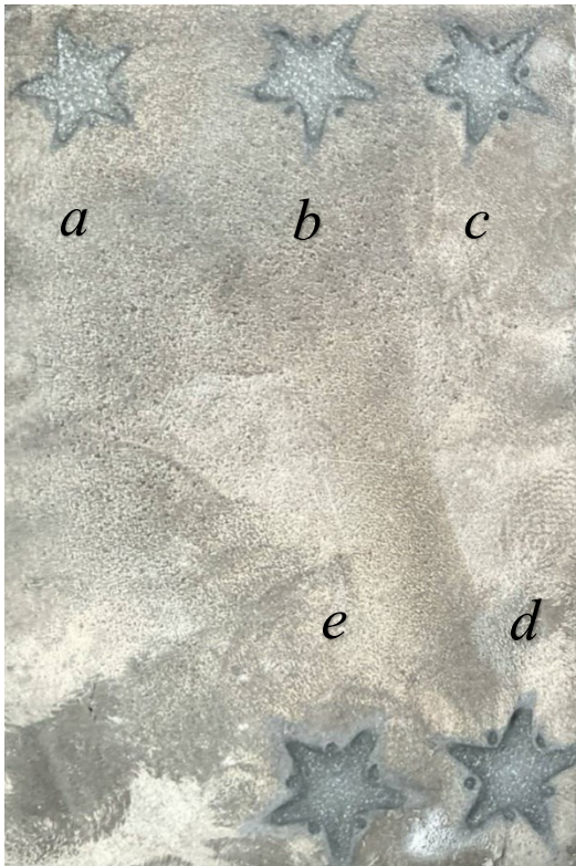
Figura 5.4-1: Vista macroscopica delle piastre lavorate in regime statico. A sinistra gli scavi superficiali a 12 V. A destra le lavorazioni a 24 V. a) S_10_12. b) S_30_12. c) S_60_12. d) S_90_12. e) S_120_12. f) S_10_24. g) S_30_24. h) S_60_24. i) S_90_24. l) S_120_24.
