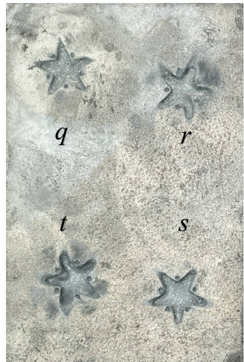
Figura 5.5-1: Vista macroscopica delle piastre lavorate in regime dinamico. A sinistra gli scavi superficiali (gap finale -0,1 mm). A destra le lavorazioni profonde (gap finale -0,5 e -1,0 mm). Riferimenti letterali da m) a t). m) D_12_0.1. n) D_12_0.2. o) D_24_0.1. p) D_24_0.2. q) D_12_0.2_-0.5. r) D_24_0.2_-0.5. s) D_12_0.2_-1.0. t) D_24_0.2_-1.0.
