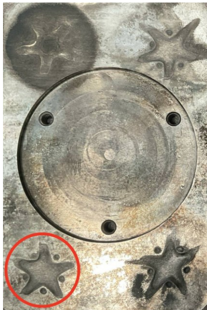
Figura 5.2-1: Impronta di validazione evidenziata (nel cerchio rosso) ottenuta con una pressione di esercizio pari al 45% (2 bar), selezionata per la pulizia del fondo e la definizione dei bordi.
