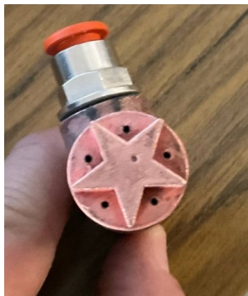
Figura 5.2-2: Configurazione finale dell'elettrodo ibrido, equipaggiato con raccordo pneumatico per filettatura gas 1/4. Si osserva l'impronta a stella estrusa a 5 mm, modifica fondamentale per sopprimere l'asportazione parassita in corrispondenza degli orifizi.
